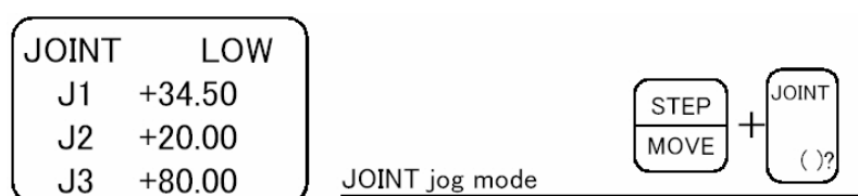
Rys. 4.4.18. Układ przycisków panelu sterowania w celu uzyskania ruchu związanego z poszczególnymi osiami 7
